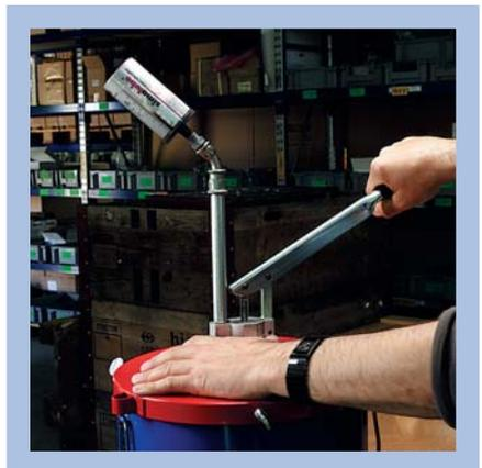
simalube lässt sich mittels eines geeigneten Abfüllgeräts (z.B. Fettpressenfüller) einfach erst- oder wiederbefüllen.
